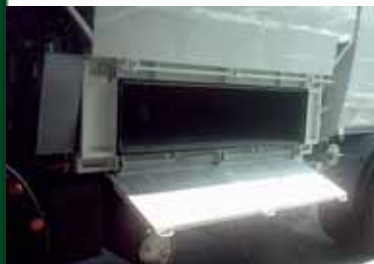
Portón de limpieza de la tolva.
