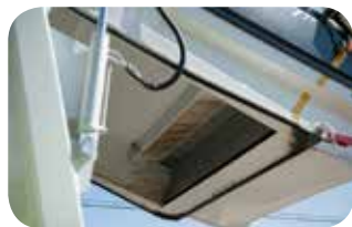
3 Junta de estanqueidad en todo el perímetro de contacto entre caja y tailgate hasta la máxima altura.
